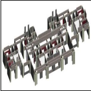
图 13 标准层排砖模型
